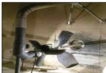
Mezclador y lanceta con los recubrimientos ARC 855 y ARC BX2 aplicados.
