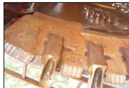
Después de 20 meses, sólo se necesitaban 5 kg de ARC BX1 para realizar las reparaciones
