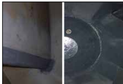
Aplicación de ARC BX2 al borde entrante.
