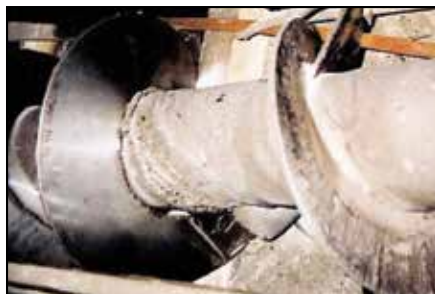
Tornillo transportador sometido a abrasión.
