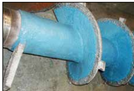
Aplicación de ARC MX1 y soldeo de las puntas.
