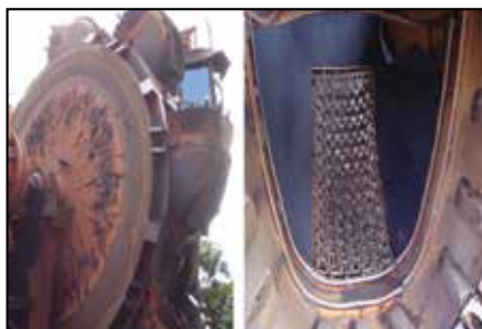
Vida útil de la reparación de 6 meses con soldaduras de endurecimiento.
