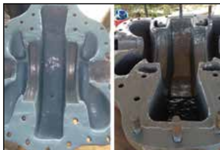
Reparación realizada en el cuerpo y la cubierta.
