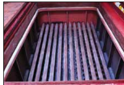
El filtro de bolsa protegido con ARC S7 estuvo en servicio durante más de 2 años sin fallas.
